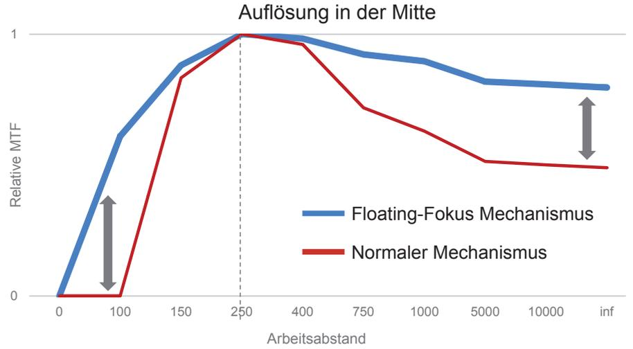
Die MTF wird nicht nur bei kürzeren Arbeitsabständen in der Bildverarbeitung, sondern auch bei größeren Abständen für intelligente Verkehrssysteme deutlich erhöht, so dass die Objektive für den Einsatz in allen Arbeitsabständen geeignet sind.
