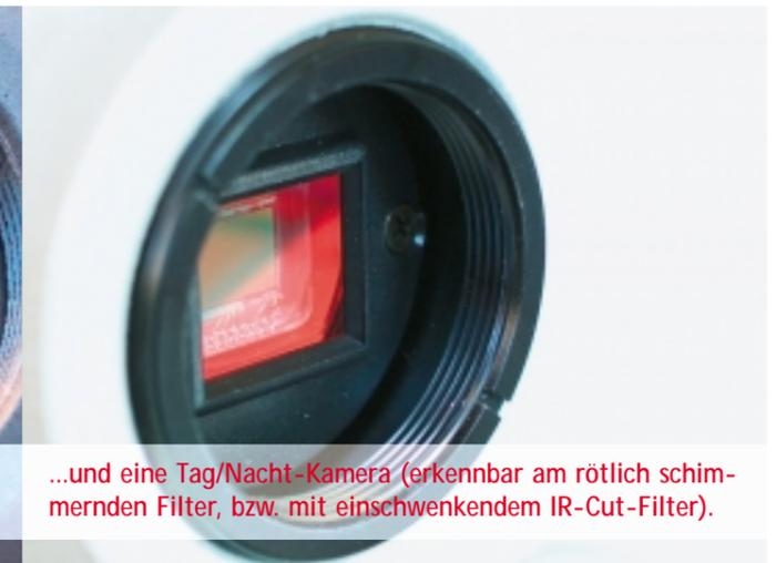
...und eine Tag/Nacht-Kamera (erkennbar am rötlich schimmernden Filter, bzw. mit einschwenkendem IR-Cut-Filter).
